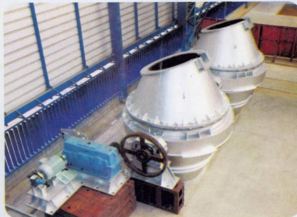
Convertedores com vaso e sistema de basculamento com motorização elétrica e pneumática
