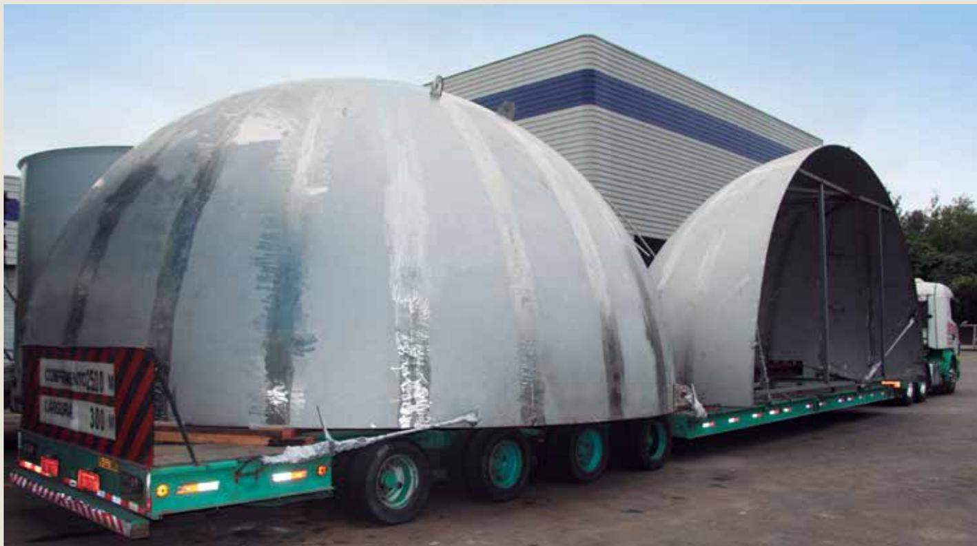
Tanque de Licor Negro (parte superior Calota Esférica em aço inoxidável duplex S32304) com 15 toneladas e 8,5 metros de diâmetro
