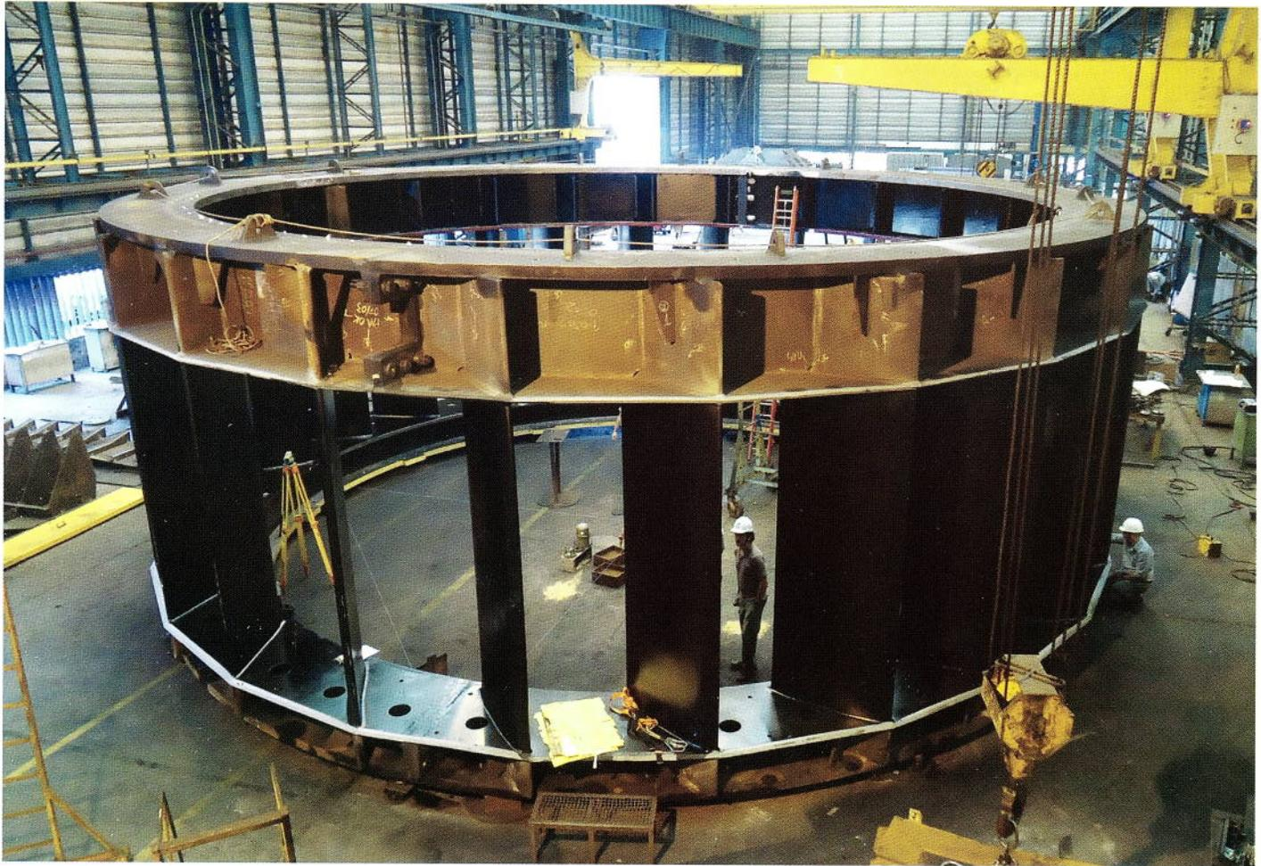
195,4 toneladas de aço foram empregados na fabricação do Pré-distribuidor
