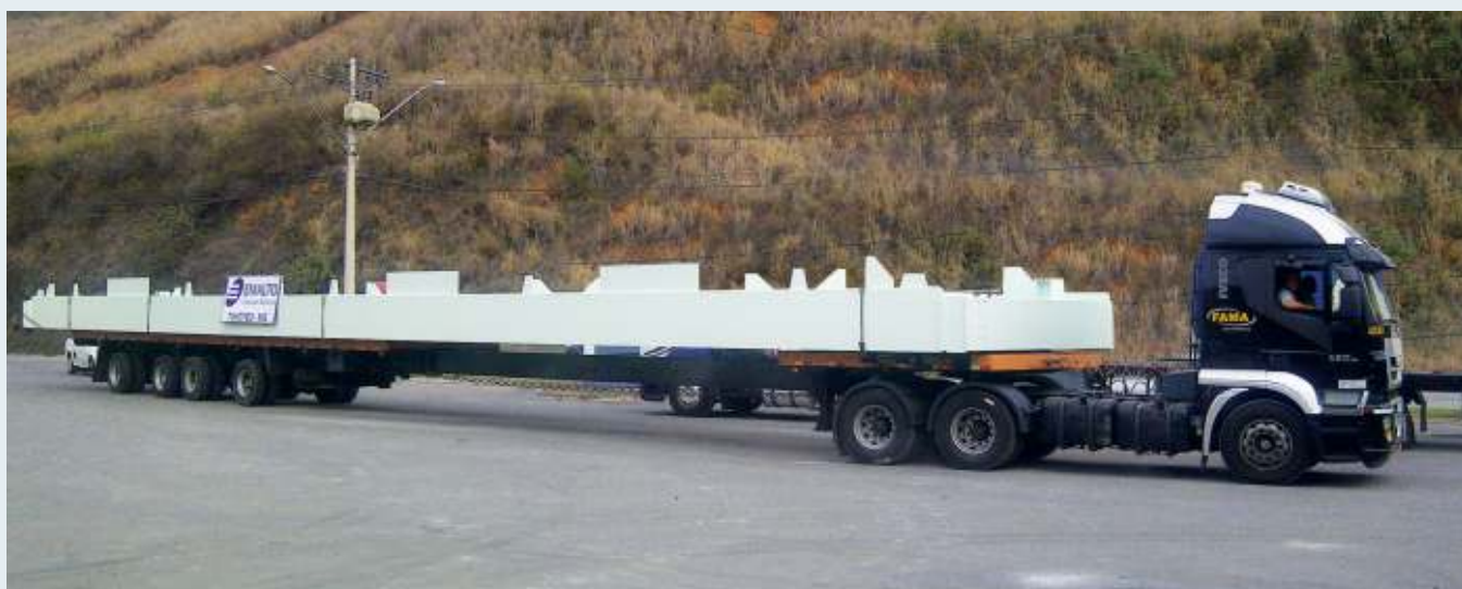
Duas vigas de rolamento de 30 metros de comprimento, pesando 42 toneladas cada, suportarão duas pontes rolantes com capacidade aproximada de 300 ton de carga total
