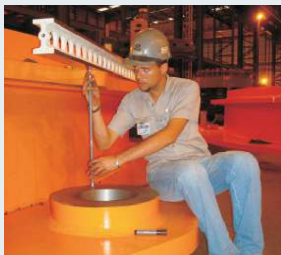
Jairo Lucas com o micrômetro realizando a inspeção de usinagem no aro de regulação fabricado para a hidrelétrica de Estreito (cliente Voith Siemens)
