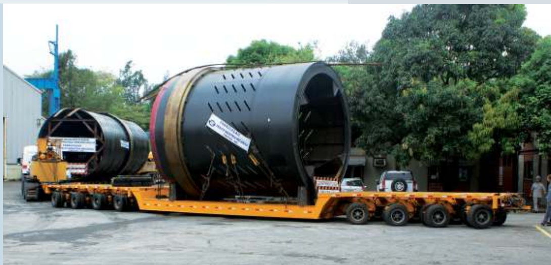
Tambor Descascador, de 210 toneladas, fabricado para a International Paper do Brasil, exigiu o maior nível de requisitos de inspeção da qualidade
