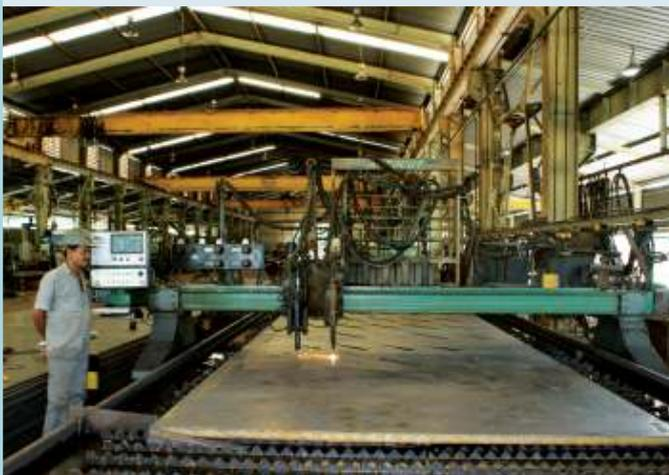
Foto maior à esq.: Corte automático da chapa especial de 60 mm que será utilizada no Tambor
