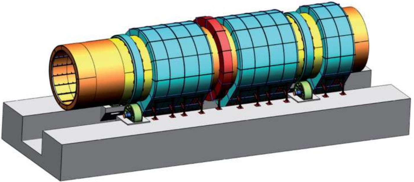
Reprodução em 3 D do projeto do Tambor Descascador: peça terá 25 m de comprimento e 6,33 m de diâmetro
