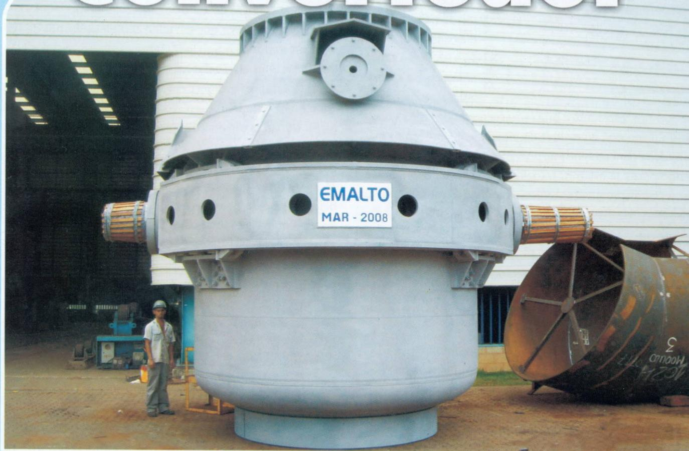
No mês de março de 2008 a Emalto concluiu a fabricação de mais um Convertedor, sendo o terceiro já fabricado em nossas instalações. Desta vez, foi um Convertedor fabricado para a Gerdau – Barão de Cocais, com capacidade de carga de 18 metros cúbicos.
