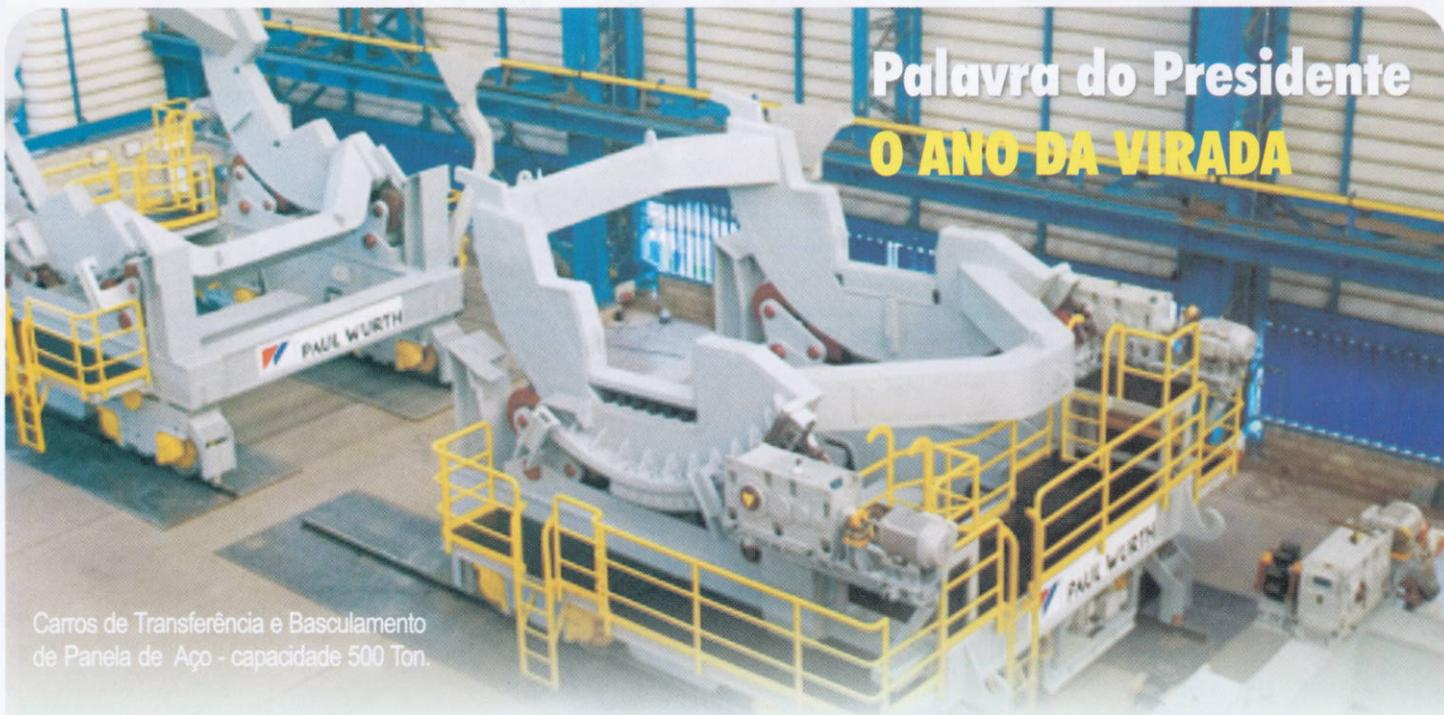
Carros de Transferência e Basculamento de Panela de Aço - capacidade 500 Ton.
